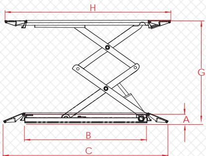
Başaran makaslı lifter; 1 ve 2 metre kaldırma yüksekliğine ve 3500 kg kaldırma potansiyeline sahiptir. Makaslı ve raylı ayak sistemi ise istenilen performansı gösterir.
