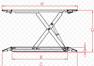
Başaran makaslı lifter; 1 ve 2 metre kaldırma yüksekliğine ve 3500 kg kaldırma potansiyeline sahiptir. Makaslı ve raylı ayak sistemi ise istenilen performansı gösterir.
