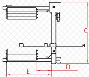
Başaran lastik taşıma krikosu; normal modelde 500 ve 1000 kg, ağır tipte ise 1,5 ton kaldırma kapasitesine sahip olup; kullanıcılar için en büyük yardımcılarından biridir.
